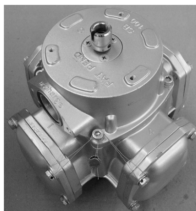
Рисунок В.2.1 – Схема пломбировки измерителя объёма ЖМТ
