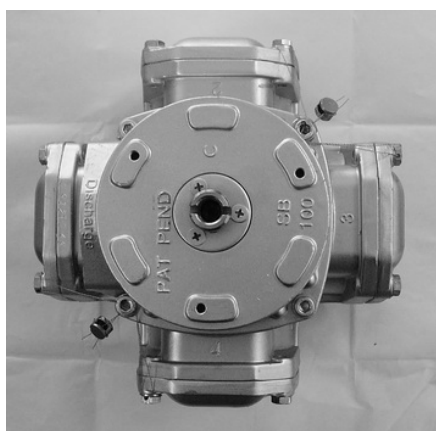
Рисунок В.2.1 – Схема пломбировки измерителя объёма ЖМТ
