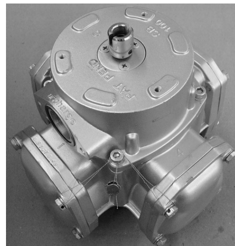
Рисунок Г.3 Пломбировка измерителя объёма
