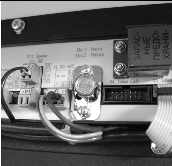
Рисунок Г.2 Пломбировка блока управления
