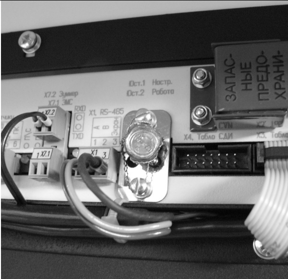
Рисунок В.2 Пломбировка фиксирующей планки блока управления
